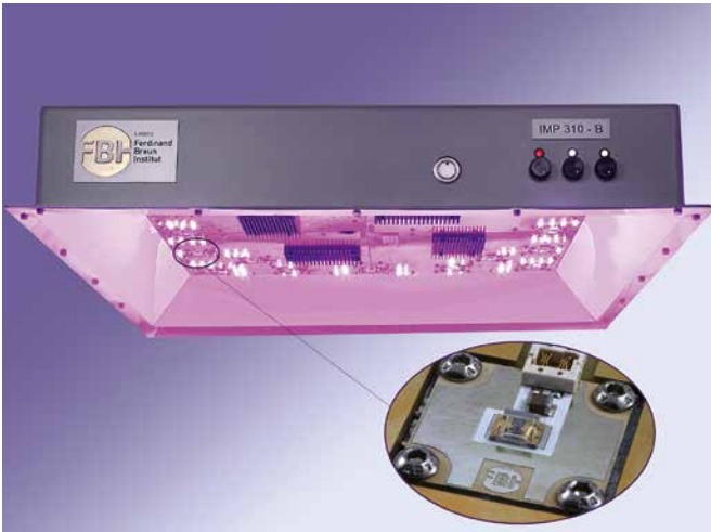
UV-B-Modul zur Pflanzenbestrahlung mit verschiedenen LEDs: UV (310 nm), blau (451 nm), rot (660 nm). Die LEDs können separat einstellt werden, um das optimale Licht für gesundheitsfördernde Pflanzenstoffe zu ermitteln (Detailaufnahme: LED) © FBH/P. Immerz
