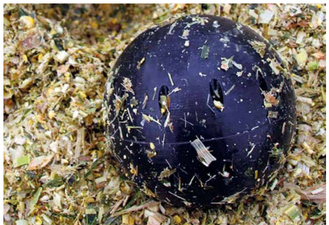
Sensorsystem zur Überwachung des Silierprozesses in der Biogasproduktion © Fraunhofer IZM
