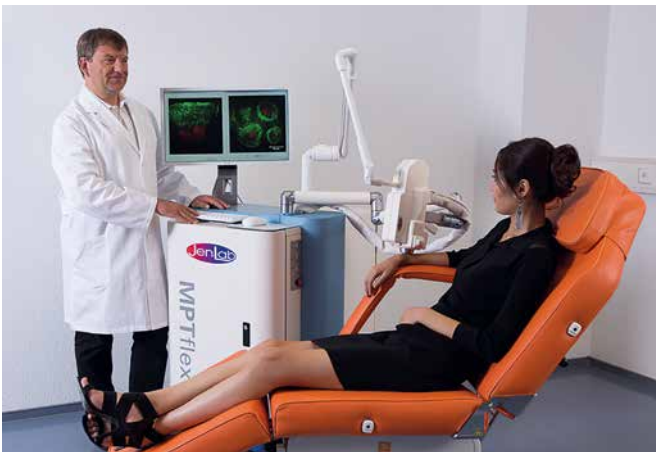
Optische Hautbiopsien können mit neuartigen Multiphotonen-Tomographen innerhalb von Sekunden gewonnen werden © JenLab GmbH
