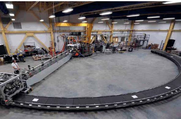
Hochauflösendes Spektrometer und integriertes Probensystem zur Untersuchung inelastischer Streuprozesse an Festkörperoberflächen © BESTEC GmbH
