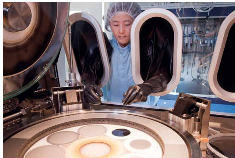
In dieser Multiwaferanlage für metallorganische Gasphasenepitaxie lassen sich atomlagendünne Materialschichten auf Substratmaterial abscheiden © FBH/schurian.com
