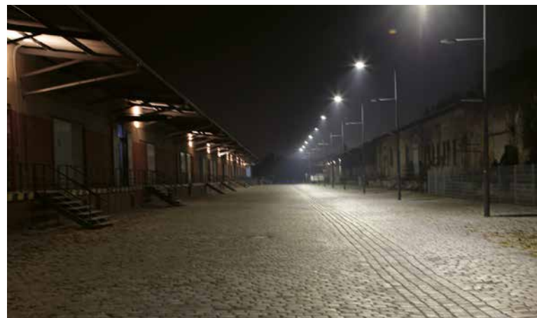
Der LED-Laufsteg ermöglicht die Erprobung und Erforschung verschiedener urbaner Beleuchtungsszenarien © TU Berlin
