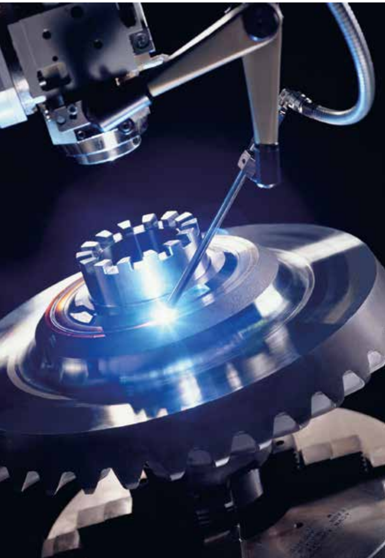
Mit CO 2 -Lasern können schlanke und tiefe Schweißnähte erzeugt werden, die höchsten mechanischen Belastungen standhalten © TRUMPF
