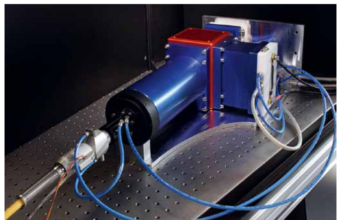
Pumpmodul für Hochenergie-KurzpulsLasersysteme mit circa 6 kW Ausgangsleistung aus der Faser © FBH/P. Immerz
