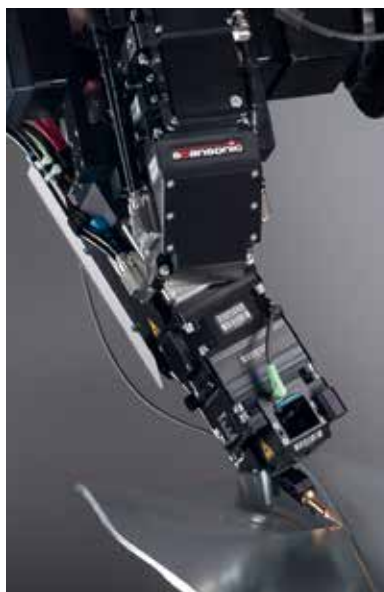
ALO3 – Laserbearbeitungsoptik mit Nahtführung mittels Zusatzdraht © Scansonic-Gruppe
