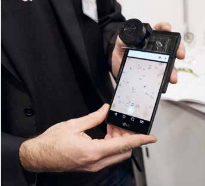
Mit dem Handy-Mikroskop von Oculyze kann man zum Beispiel automatisiert Zellen zählen
